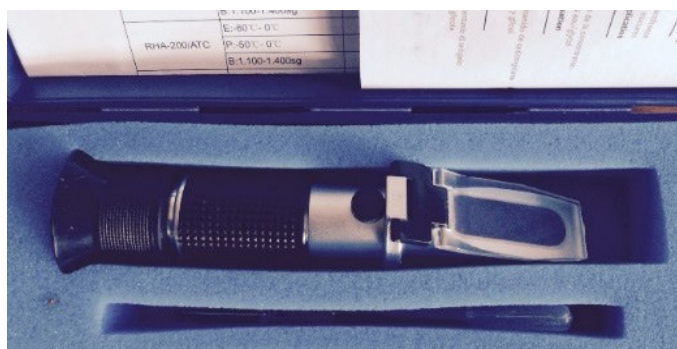
Abb. 6: Refraktometer zur Bestimmung des Frostschutzgehaltes der Sole.
