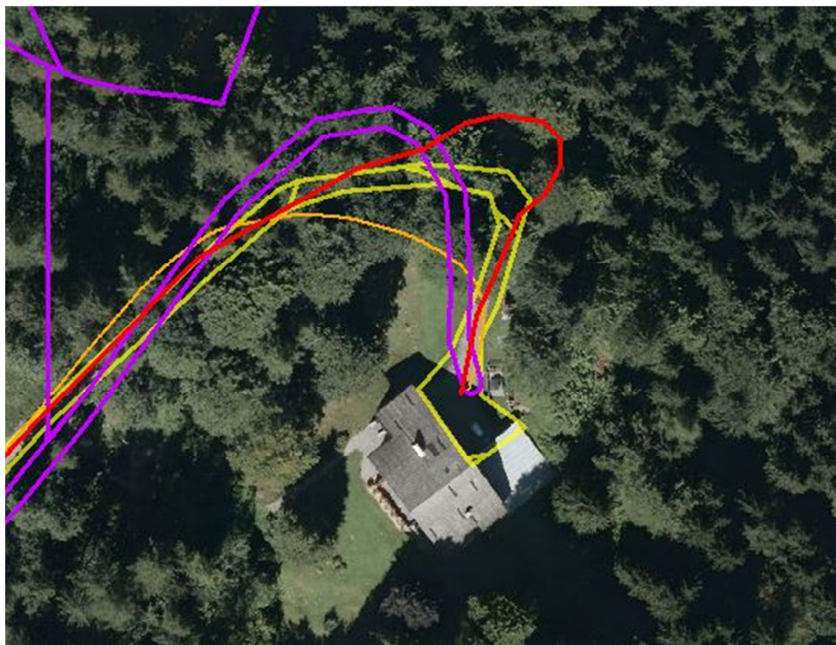
Abbildung 1: Die Lage einer Zufahrtsstraße zu einem Haus nach der DKM (in Gelb), nach dem Flächenwidmungsplan (in Violett), nach dem Straßenachsenlayer (orange Achsenlinie) der Bundesländer und die tatsächliche Lage nach dem ALS-Reliefmodell als rote Achsenlinie (aus Perzl et al. 2014 a, Orthofoto: WMS-Dienst des LFRZ).
