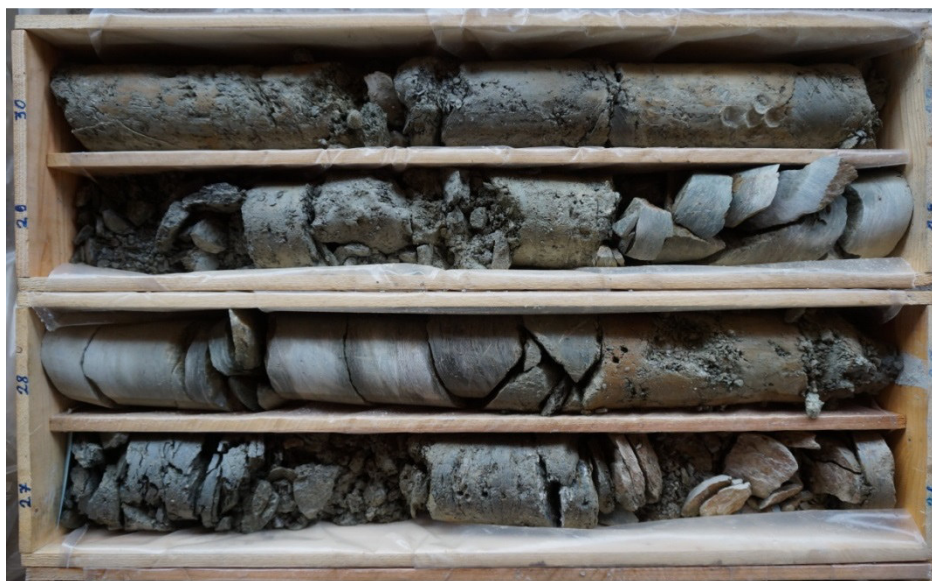
Abb.7: Kernstrecke der Bohrung PKB – KB 05/16 im Abschnitt Bohrmeter 26 – 30 (Endteufe)
