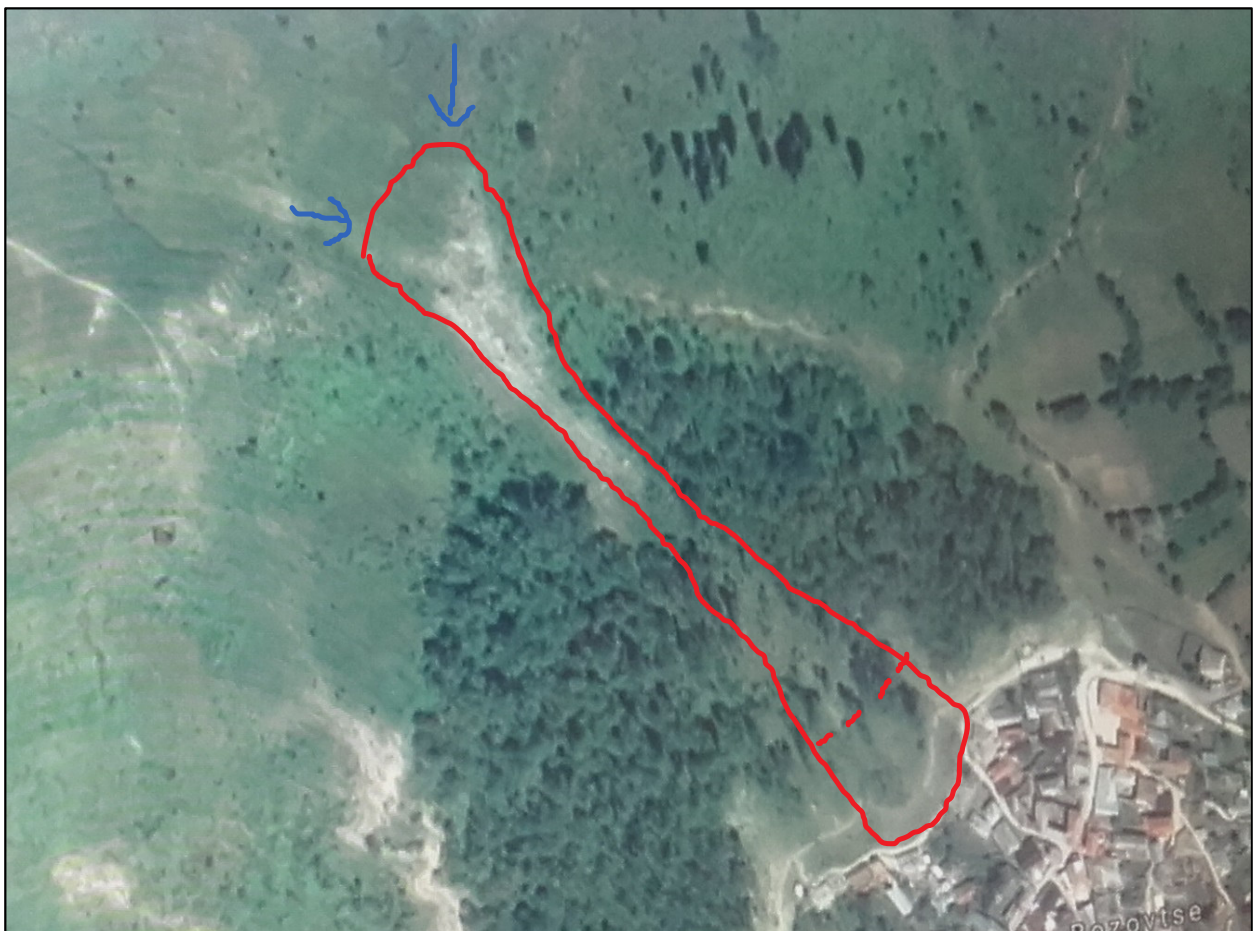
Abbildung 3: Die Umgrenzung der Massenbewegung bergseitig von Bozovtse. Der derzeit aktive Bereich reicht bis zur strichlierten Linie. Die blauen Pfeile kennzeichnen Quellabflüsse. Quelle: googlemaps
